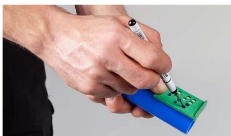
Figure 2 - Repérer la profondeur de pénétration
