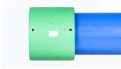
Figure 12 - Pour un processus optimal de soudure, les tubes doivent être placés en bout à bout dans le manchon. La profondeur minimale d'introduction doit toujours être respectée
