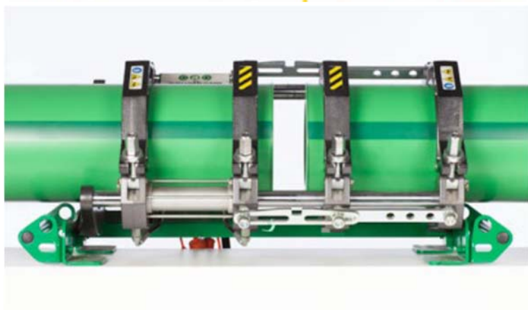
Figure 17 : Séparer les éléments et retirer le fer chauffant
