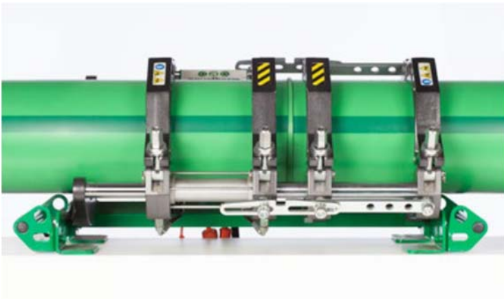
Figure 18 : Assembler les tubes et laisser refroidir
