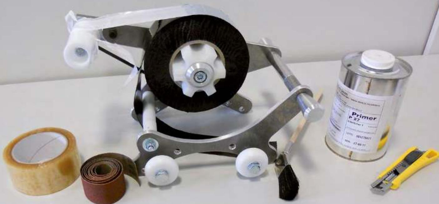
L'ensemble de l'outillage d'enroulement illustré par l'application de la bande de protection MONO TOP 40 n'est pas obligatoirement nécessaire.
