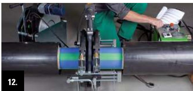
Avec le système hydraulique amener les tubes en contact avec l'appareil de chauffe et mettre sous pression comme défini.
