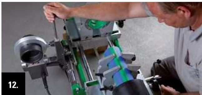
Séparer à nouveau les traîneaux et retirer le bouton de calibrage de la profondeur d'emboîtement.
