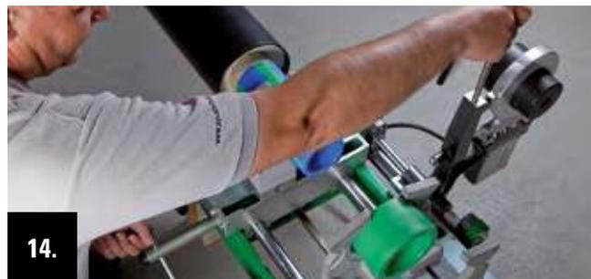
Après écoulement du temps de chauffe, écarter les traîneaux avec la manivelle et relever l'appareil de soudage.
