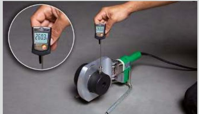
Mesure de la température sur l'appareil de soudage manuel aquatherm (1400 W)
