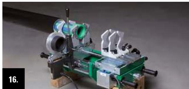
Après écoulement du temps de refroidissement, desserrer les étriers de maintien et tourner la machine à 180°.
