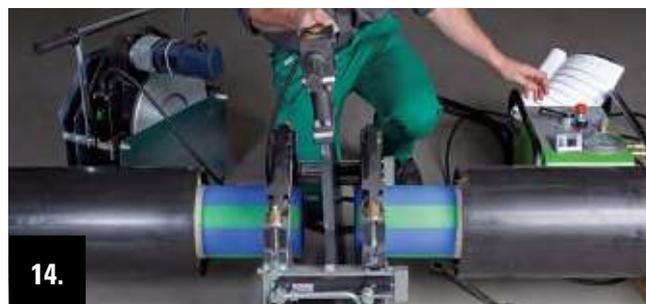
Après écoulement du temps de chauffe, écarter hydrauliquement les traîneaux et retirer l'appareil de chauffe.
