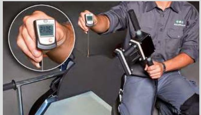
Mesure de la température sur la machine de soudage bout a bout aquatherm
