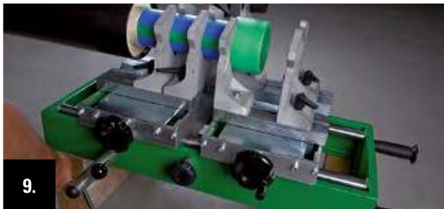
A l'aide de la manivelle de déplacement rapprocher les traîneaux jusqu'à ce que le manchon et le tube soient en contact.
