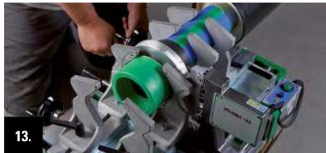
Descendre l'appareil de soudage et rapprocher les traîneaux à l'aide la manivelle.
