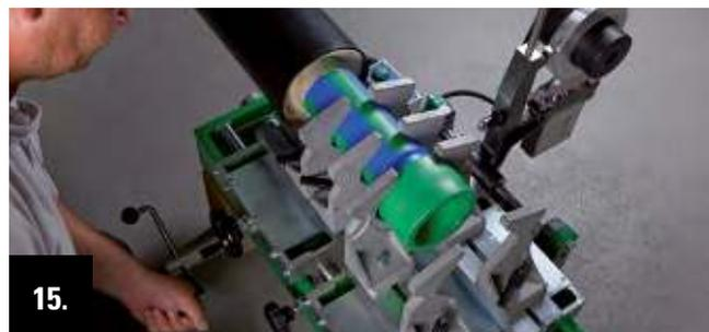
Rapprocher à nouveau les traîneaux à l'aide la manivelle jusqu'à butée.
