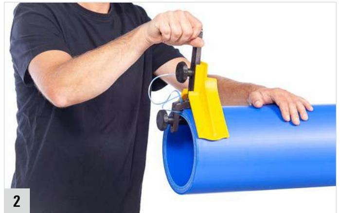
Chanfreiner l'extérieur du tube à l'aide de l'outil de chanfreinage (voir tableau des longueurs de chanfreinage minimales).
