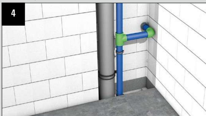
Réalisation d'un bras d'absorption
