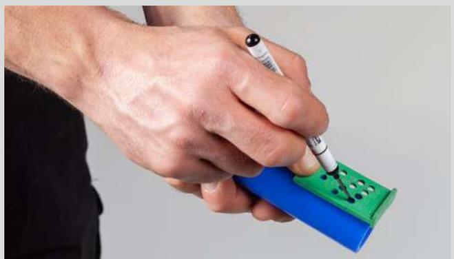
Traçage de la profondeur d'emboîtement
