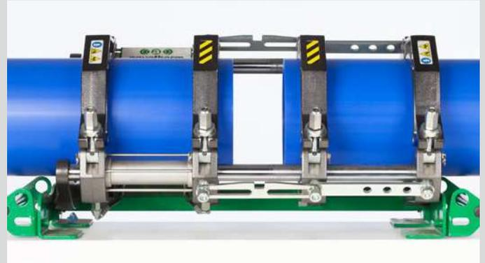
Guider et fixer les éléments a assembler et insérer le robot
