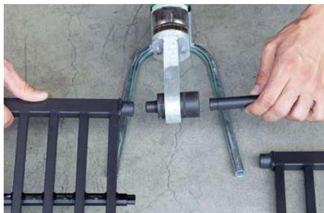
**3.** Après écoulement du temps de chauffe de 5 secondes, les éléments sont retirés des douilles de soudure et ...
