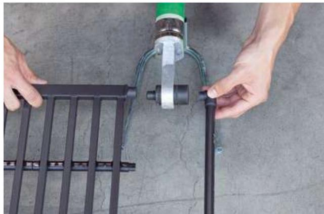
**2.** Introduire le coude 90° mâle/femelle (16 mm) dans la douille de chauffe, de même et simultanément que le manchon femelle sur la douille de chauffe.
