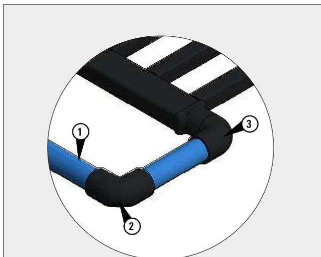
1. Conduite de raccordement tube PP pour grilles (Art.-Nr. 81006)
