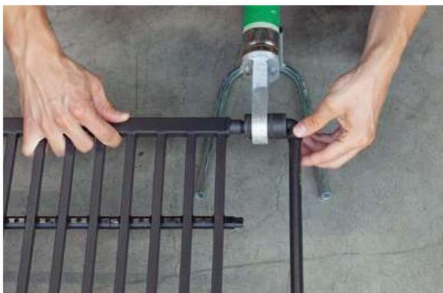
**3.** Après respect du temps de chauffe adéquat de 5 secondes, les raccords sont retirés des douilles de chauffe ...
