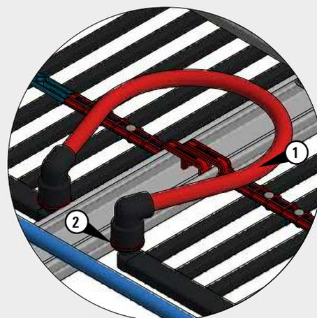
1. Flexible de raccordement avec raccord rapide 90° (Art.-Nr. 81032)
